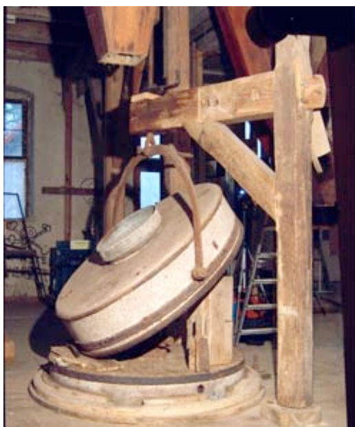
geöffneter Mahlgang, Läufer im Steinheber Der Läufer mit einem sog. Steinheber abgehoben und seitlich auf dem Boden abgelegt (siehe Abb.). Das Steinschärfen galt bei den Müllern und seinen Gesellen
